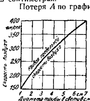
Фиг. 55. Зависимость предельной скорости воздуха от диаметра трубы в свету.
