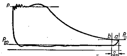
Фиг. 65. Индикаторная диаграмма воздушного компрессора Г. Т. Ворхиса.
