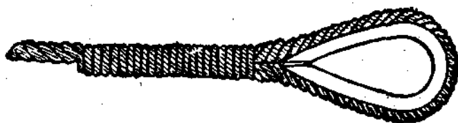
Рис. 37. Упрощенный способ заделки коуша для небольших нагрузок
