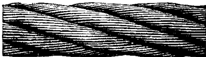
Рис. 109. Трос конструкции 6 \times 37 + 1
