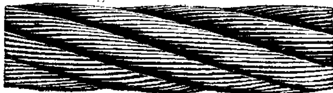
Рис. 108. Трос конструкции 6 \times 24 + 7
