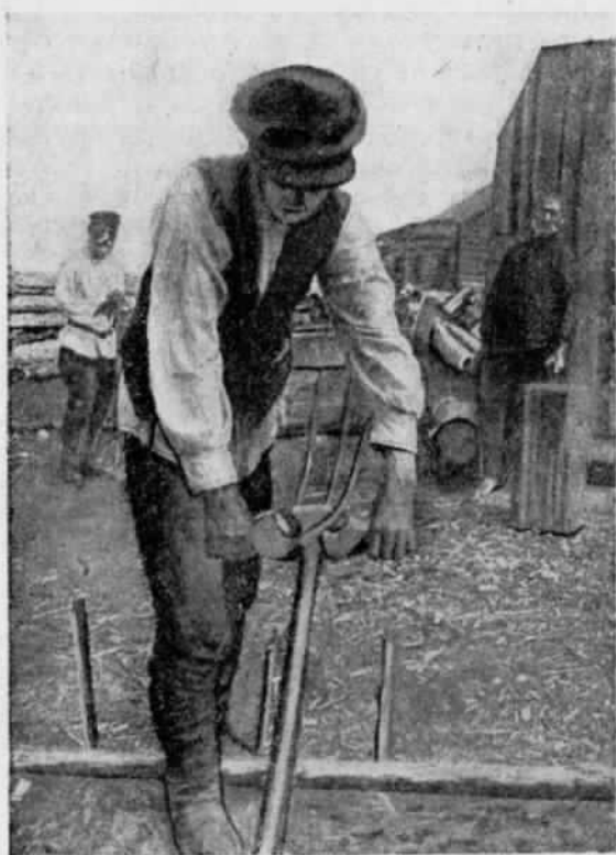
Рис. 22. Ситень для регулирования скручивания мочальных канатов
