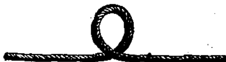
Рис. 34. Колышки, образующиеся на тросе при неправильном его разматывании
