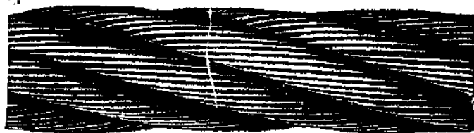
Рис. 107. Трос конструкции 6 \times 12 + 7
