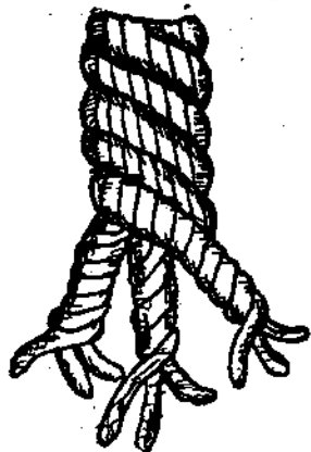
Рис. 6. Девятипрядный пеньковый канат кабельной свивки
