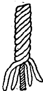
Рис. 5. Четырепрядный пеньковый канат простой свивки
