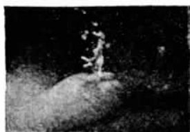
Рис. 38. Купол, образующийся над воронкой при падении неотшлифованного шара.
