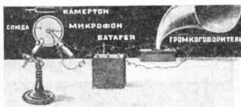
Рис. 82. Когда камертон держат в плоскости диска, то громкоговоритель издает слабые звуки; когда же камертон держат с той или другой стороны диска, то громкоговоритель громко ему вторит.
