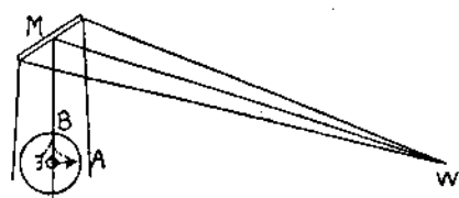
Рис. 15. Схема расположения приборов в опыте с отражающей поверхностью. Звук свистка W отражается зеркалом М и действует на чувствительное пламя. Пламя это расположено так, что оно чувствительно к звукам, распространяющимся в том направлении, в котором находится зеркало, но нечувствительно к звукам, исходящим непосредственно из точки W .
