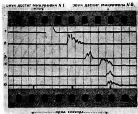
Рис. 90. Кусок кинематографической ленты со «следами» от выстрела германской 15-сантиметровой гаубицы. Горизонтальные линии,—это записи, сделанные пером автомата; пока волна выстрела не доходит до соответствующего микрофона, эти линии представляют собою непрерывные прямые. Вертикальные прямые указывают время; каждое деление их соответствует \frac{1}{100} секунды.
