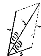
Рис. 63. Векторное сложение моментов орбиты l и момента спина s в общий вращательный момент.
