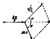
Рис. 94. Диаграмма импульсов при Комптоновском рассеянии.
