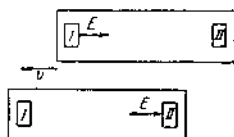
Рис. 20. Иллюстрация мысленного эксперимента Эйнштейна для доказательства соотношения E = mc^2 . Прибор I излучает по направлению к приемнику II определенную световую энергию E , вследствие чего весь ящик испытывает смещение, обратное движению светового сигнала.
