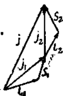
Рис. 67. Схема так называемой связи ( j ); в первом приближении моменты орбиты и спина каждого электрона складываются в одну результирующую \mathbf{j}_1 , а векторная сумма векторов \mathbf{j}_1 образует общий вращательный момент \mathbf{j} .
