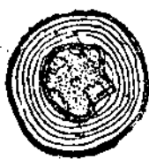
44. Гнили: а—сердцевинная, б—периферическая, в—смешанная
