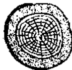
44. Гнили: а—сердцевинная, б—периферическая, в—смешанная
