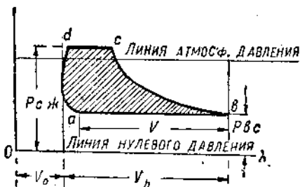
Фиг. 57. Индикаторная диаграмма поршневого воздушного насоса, работающего с перепуском воздуха.
