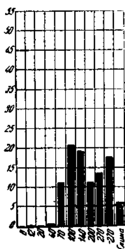
Фиг. 37. Типовая диаграмма зернистости тощей земли.
