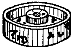
Фиг. 11. Шкив с газовыми раковинами.
