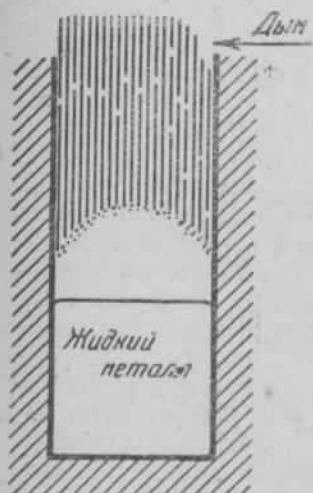
Фиг. 15. Покрытие формы сажей от угля.
