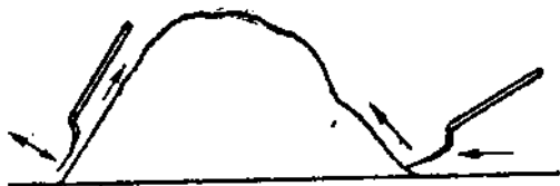
Фиг. 84. Оставшийся песок сгребается лопатой в кучу и приглаживается ударами тыльной стороной лопаты.
