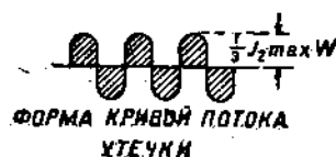
Рис. 176. Поток утечки в магнитной цепи шестифазного трансформатора, работающего на выпрямитель, при включении его обмоток по схеме звезда-звезда.
