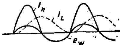
Рис. 123. Кривые э. д. с. и токов при работе вентиля на чисто реактивную нагрузку (случай 2-й).
