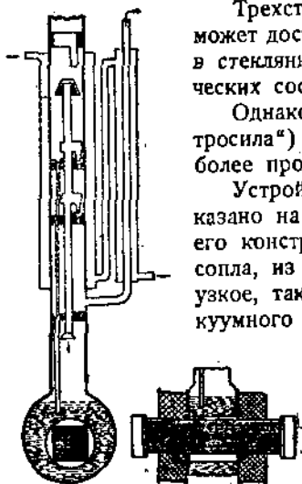
Рис. 236. Трехступенчатый ртутный конденсационный насос фирмы AEG (схема устройства).
