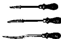
542. Инструменты, облегчающие пришабривание подшипников.
