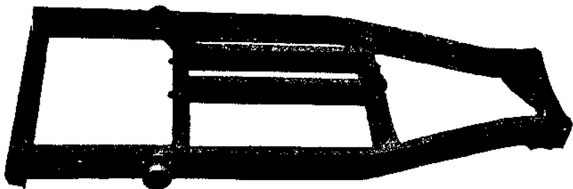
394. Рама трактора «Харт-Парри», выполненная из прокатных стальных балок.
