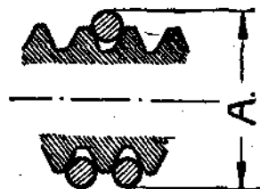
Рис. 404. Измерение резьбы при помощи трех проволок.
