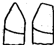
Рис. 209. Два резца (сравнение теплоотвода).
