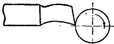
Рис. 223. Отрезной пружинный резец.
