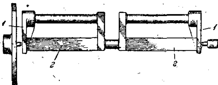
Рис. 434. Обточка коленчатого вала.
