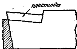
Рис. 243. Гнездо для пластинки Видиа в болванке из углеродистой стали.
