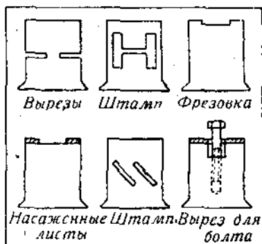
Фиг. 45. Насыщение железа путем вырезов в поперечном сечении.
