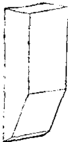
Рис. 75. Дешевое и удобное зубило для раскалывания кирпича.
