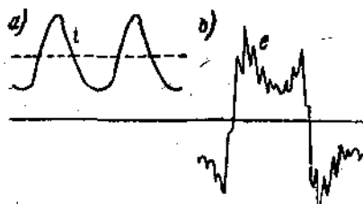
Рис. 167. Кривые изменения тока возбуждения (а) и э. д. с. статора (б) в однофазном генераторе без успокоительной обмотки.
