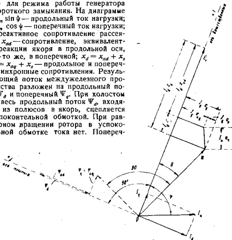
Рис. 253. Диаграмма Blondеля для ненасыщенной машины.
