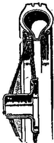
Фиг. 382. Колесо с проволочными спицами со штампованной ступицей.
