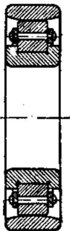
Фиг. 351. Самоустанавливающийся роликовый подшипник с проточенными роликами.
