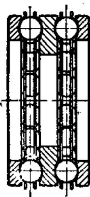
Фиг. 336. Осевой шарикоподшипник двойного действия.
