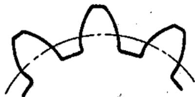
Фиг. 440. Смещенный профиль: зубья не подрезаны.
