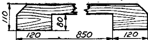
Фиг. 17. Хомут для стягивания коробки
