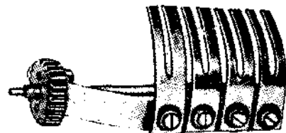
Фиг. 121. Щетки искателя круглого типа.
