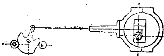
Фиг. 236. Схема клапанного механизма Лентца для вертикальных машин.
