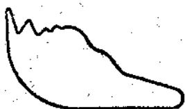
Фиг. 38. Удар воды в индикаторе или слабая пружина, не преодолевающая инерции движущихся масс индикатора.
