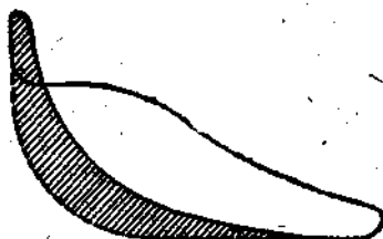
Фиг. 50. Высокое сжатие благодаря раннему закрытию выпускного канала. Такая же диаграмма может получиться при малом давлении впуска.
