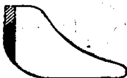
Фиг. 39. Слишком длинный шнур и ходоуменьшитель. Часть хода поршня машины проходит при неподвижном барабане индикатора. Характерен стук последнего.
