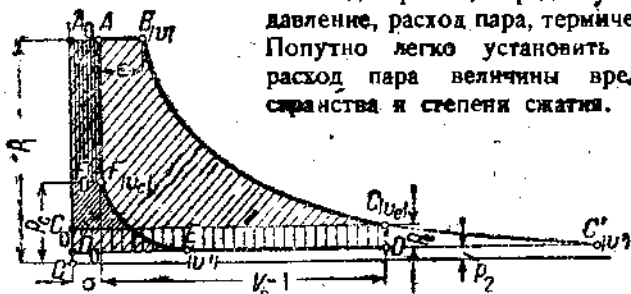
Фиг. 52. Индикаторная диаграмма с адиабатическим расширением и сжатием пара.
