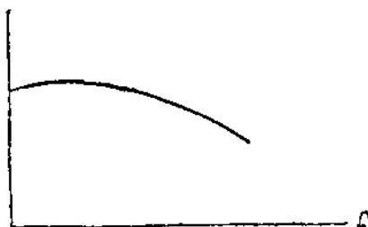
Фиг. 151. Характеристика центробежного насоса, пригодного для параллельной работы.
