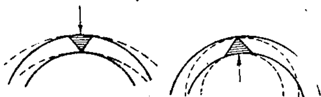
Рис. 5. Кромки шва скашиваются со стороны внешнего усилия (давления)
