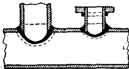
Рис. 42. Приварка патрубков и ответвлений.
