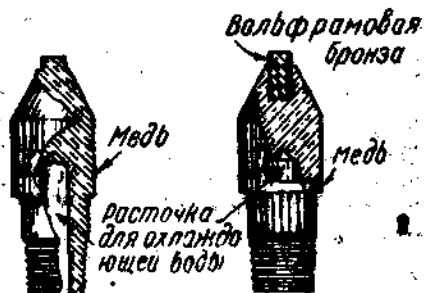
Рис. 132. Охлаждаемые водой электроды для точечной сварки. (Налево — сплошные медные, направо — из вольфрамовой бронзы).
