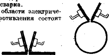
Рис. 105. Сходящиеся роликовые электроды.
