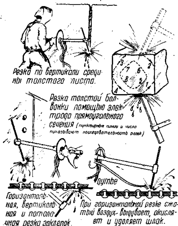
Рис. 191. Резка вольтовой дугой.
