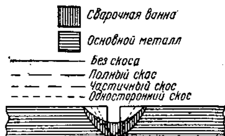
Рис. 6. Диаграмма скашивания кромок под сварку.
