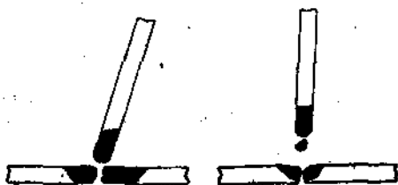
Рис. 65. Схема сварки угольным и металлическим электродами.
