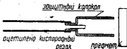
Рис. 171. Тип германской горелки для подводной резки.
