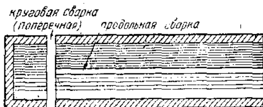
Рис. 17. Материал, подготовленный для сварки встык и продольным швом (толщина материала менее 1,5 мм.)
