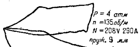
Фиг. 56а. Индикаторные диаграммы двухступенчатого компрессора зав. „Борец“.
