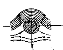
Фиг. 221. Суммарный поток \psi_1 + \psi_2 , вызывающий силу, действующую по нормали к потоку.
