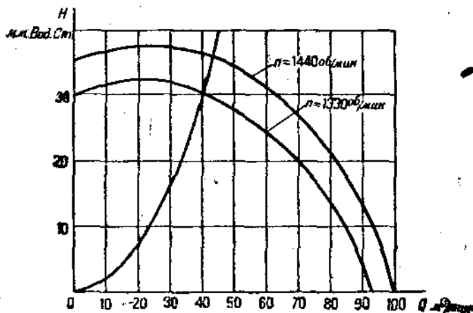
Фиг. 327. Регулирование величины подачи оборотами.
