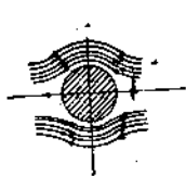
Фиг. 219. Обтекание неподвижного цилиндра плоско-параллельным потоком \psi_1 .
