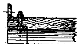
Рис. 30. Соединение деревянной трубы с железной.
