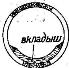
Рис. 97. Трубы со вкладышами при перемещении воды с большим количеством наносов.
