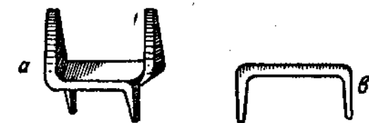
Рис. 18. Закрепление проволоки на звеновой трубе.
