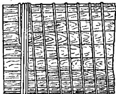
Рис. 62. Схема закрепления проволоки на звеновой трубе.
