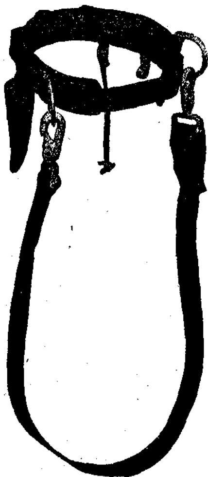
Фиг. 165. Предохранительный пояс.
